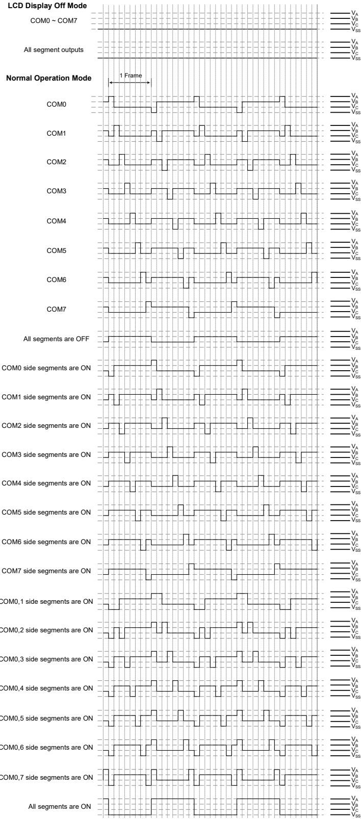
LCD 驱动输出 - B 型, 1/8 Duty, 1/3 Bias
